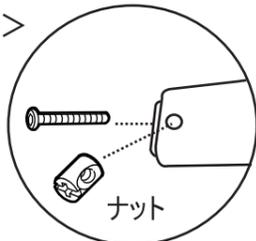
図のように板の裏側にある穴にナットをプラス(+ )が見えるようにはめ込んでください。ナットのプラス(+ )の十字が端まで切れている方向とボルトを入れる方向を平行にしてください。その後、図のようにボルトで固定してください。
