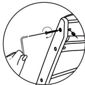
レンチの先をボルトの穴に入れ時計方向にまわします。
